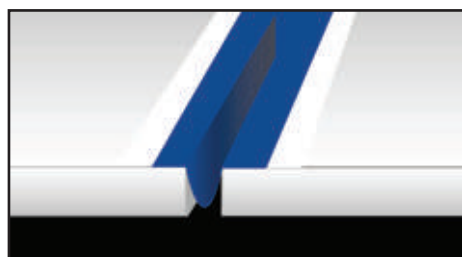
Расположение Мареband в форме буквы Ω в деформационном шве
